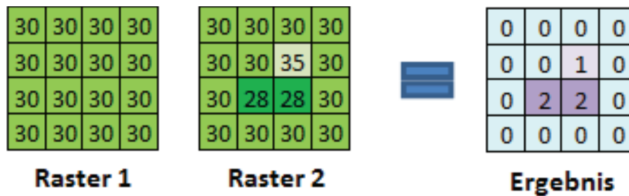
Abbildung 5.2.: Links befinden sich die beiden Eingabe-Raster. Auf der rechten Seite das Ergebnis mit der Einteilung in Regionen. Quelle: ArcGis [0204]
