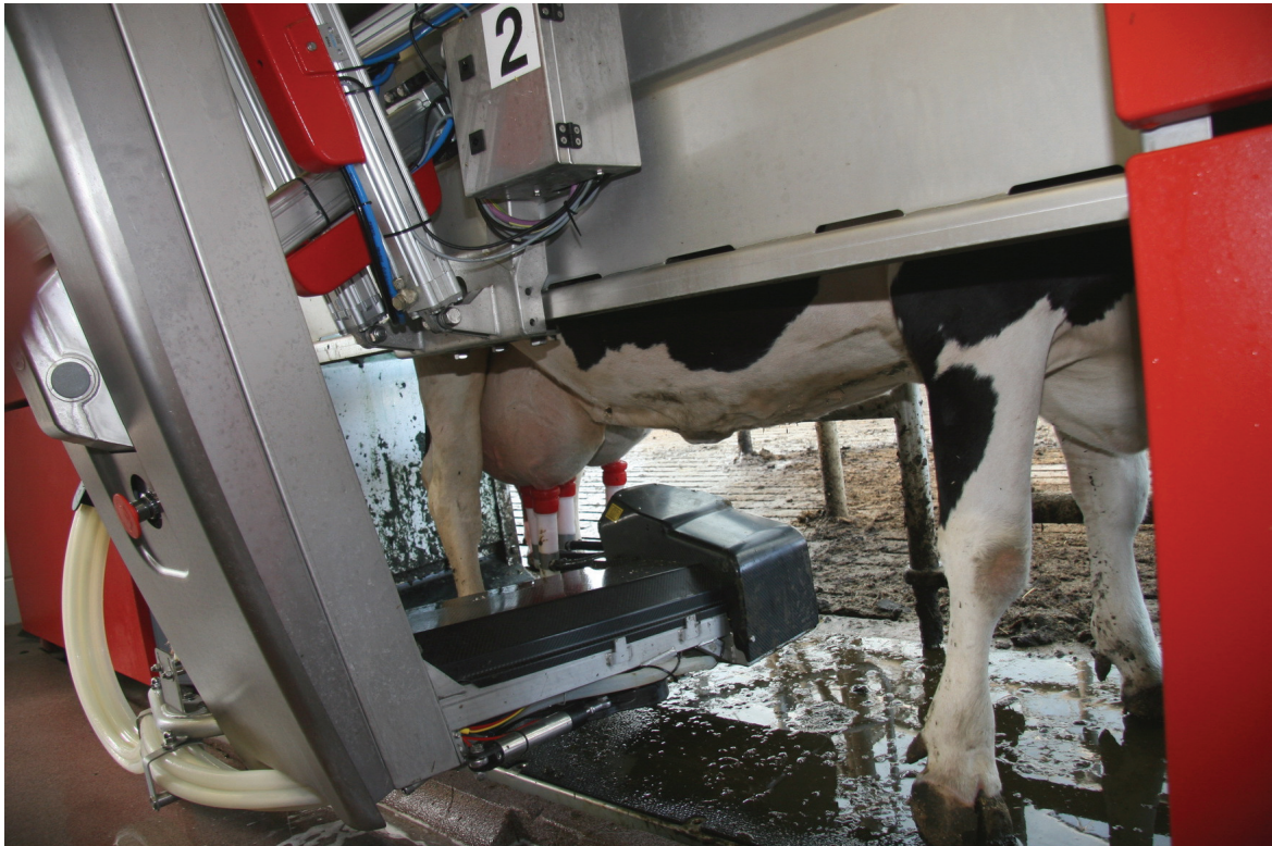
Abbildung 13: Lely Astronaut A3 Next beim Melken Quelle: FLEEGE 2009 A
