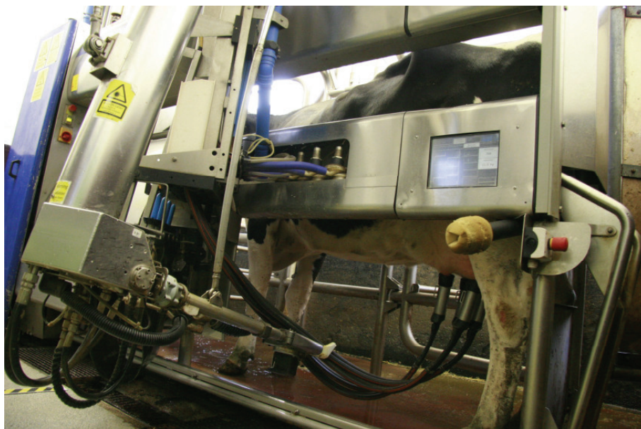
Abbildung 16: Ansetzen des Roboterarms beim DeLaval VMS Quelle: FLEEGE 2008
