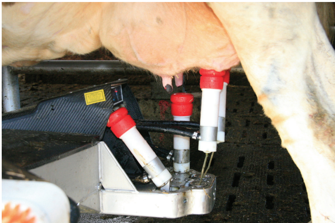
Abbildung 12: Lasergesteuertes Ansetzen des Roboterarms bei Lely Quelle: eigene Aufnahme
