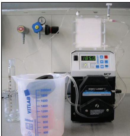
Abbildung 8: Aufkonzentrierung mit Hilfe der Ultrafiltration
