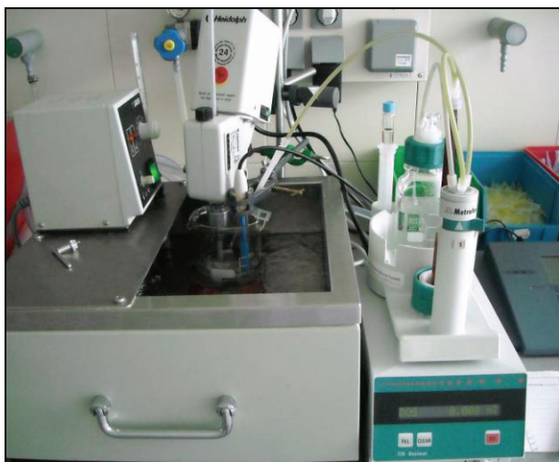
Abbildung 10: Versuchsaufbau zur Bestimmung von PE mittels Dosimaten
