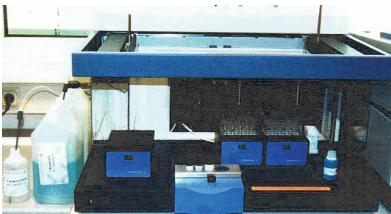
Abbildung 9: Pipettierautomat des D-Counts (aus Handbuch D-Count Rapid microbiology testing, 2003)
