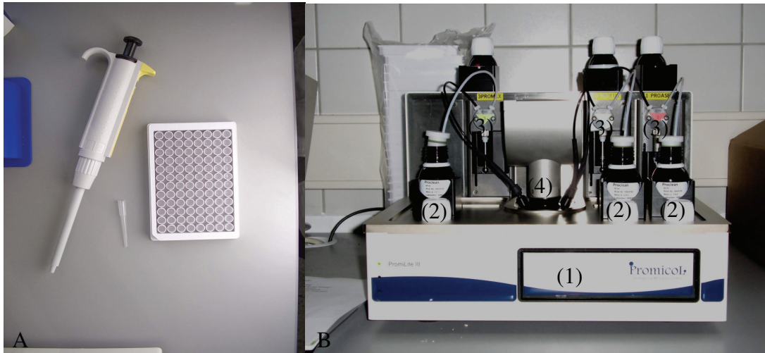
Abbildung 5: Mikrotiterplatte (A), Promilite III System (B) mit Reagenzien (Diplomarbeit - Methodenvergleich zur Keimdetektion in Erfrischungsgetränken und Fruchtsäften, 2008)
