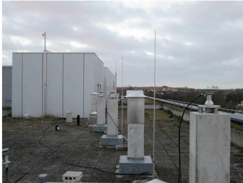
Abbildung 11: Messpfeiler und anliegende Beobachtungsstation (Fotografie: M. Scholz)
