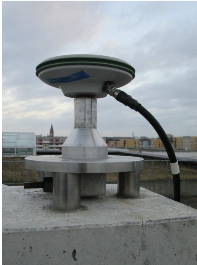
Abbildung 12: GMX902GG-Empfänger mit Höhenadapter (Fotografie: M. Scholz)
