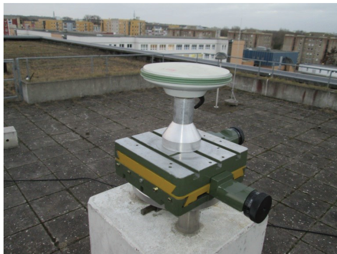
Abbildung 18: AS10 auf Kreuzschlitten (Fotografie: M. Scholz)
